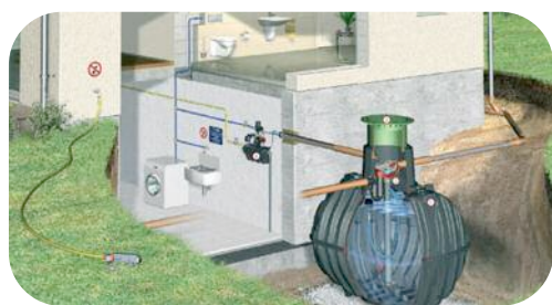
Système de récupération des eaux de pluie © GRAF
